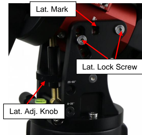
Figure 18. Adjust latitude
