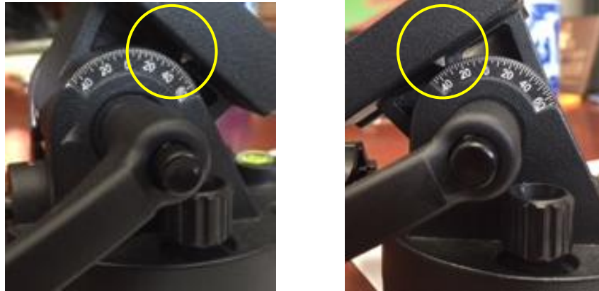
Figure 11. Alt-azi base latitude settings
